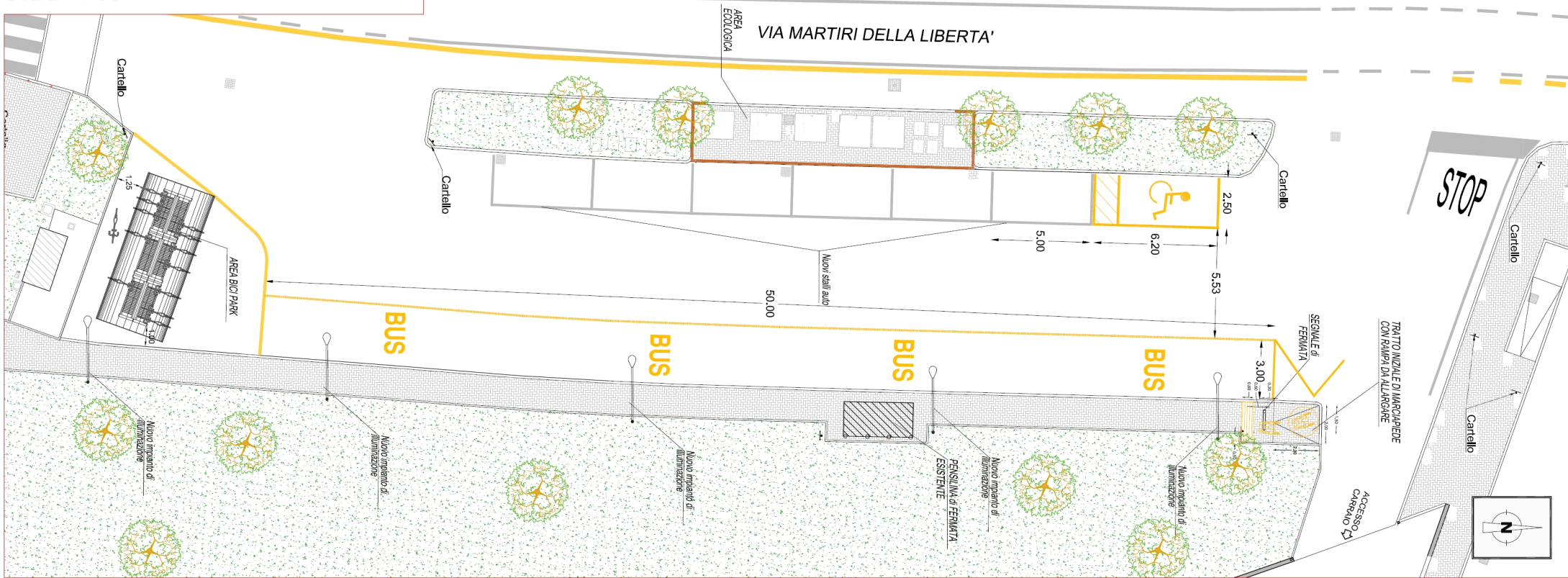
Zona di intervento 4.1 - Realizzazione di piattaforma intermodale in Via Martiri Planimetria di progetto Scala 1:200
